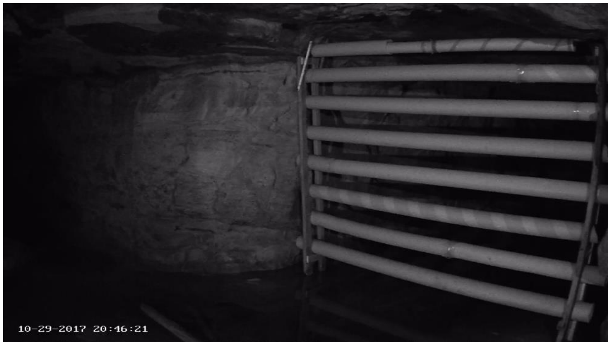
Foto 3. Ülgase koobastes projekti alfaasis testitud EUROBATS juhiste järgi katsetamiseks tehtud papptorudest trellid. Foto: Projekti looduskaamera.
