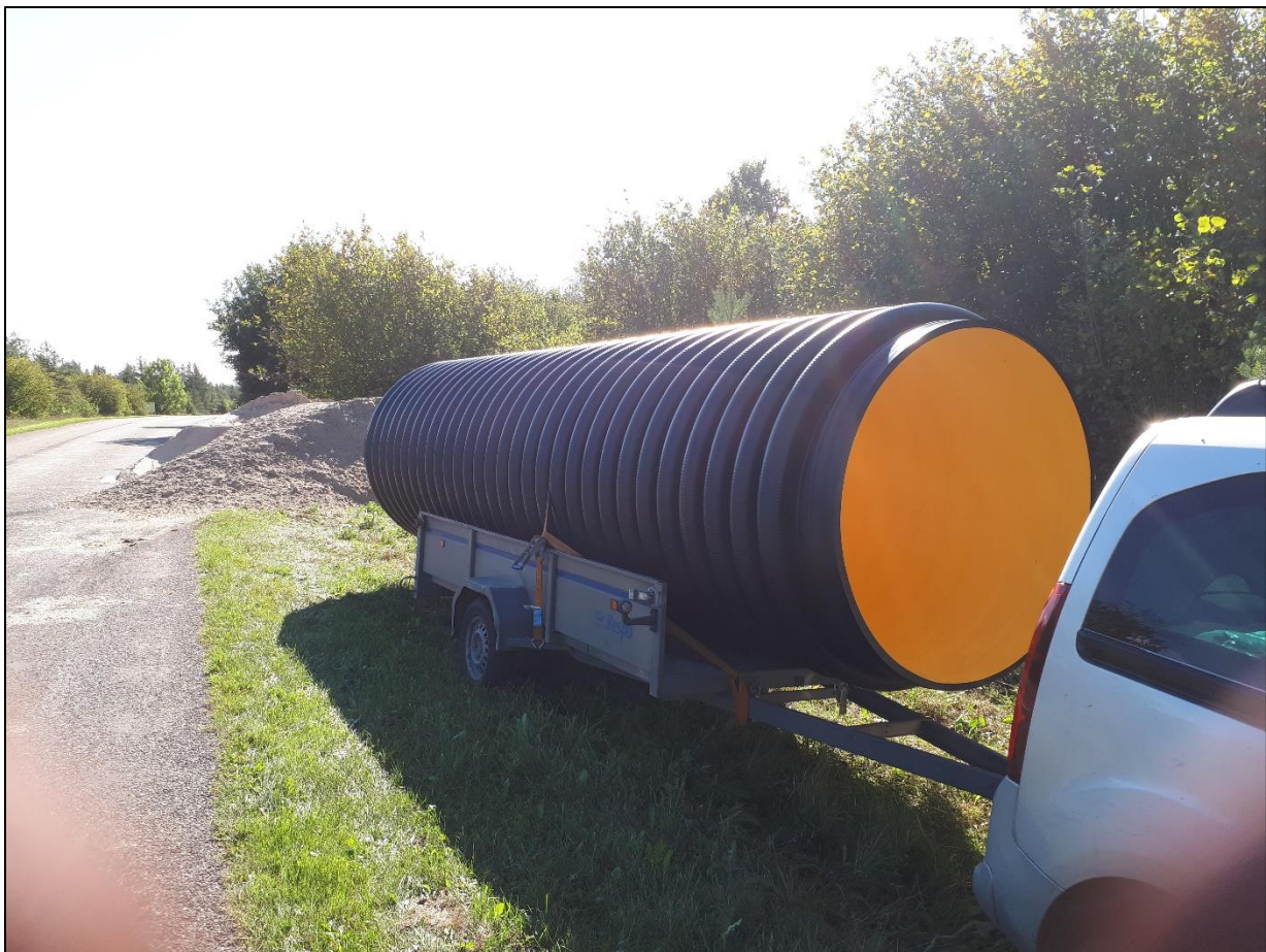
Foto 1. Tavapäraselt maanteetruubina kasutusel olev tugevdatud koormustaluvusega plastiktroube sobib hästi ka nahkhiirte talvituspaika. Foto: Lauri Klein.
